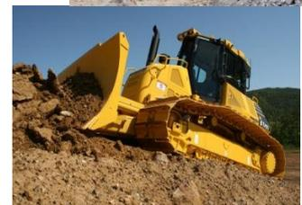
**Bulldozer:** Son tractores con una cuchilla montada en su frente de avance. Se utilizan para excavar, empujar, verter, extender y escarificar.
