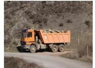
**Camión de Volteo:** Sirve para el transporte de materiales pesados.
