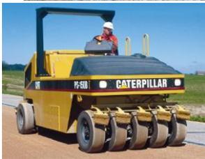
**Compactador de asfalto con neumático:** Este equipo utiliza llantas suaves como rodillos, los cuales son apropiados para compactar materiales tanto cohesivos, como no cohesivos, tales como suelos arenosos, arcillas, mezclas de grava, suelos estables, concreto bituminoso, concreto rígido, etc.
