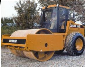
**Vibro Compactador:** Equipo para vibrar rasantes y/o suelos, compacta hasta dar densidades aptas para la aplicación de asfaltos fríos o calientes.
