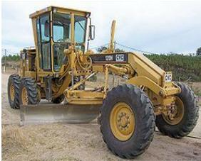
**Moto Niveladora y/o Conformadora:** Es una máquina de construcción que cuenta con una larga hoja metálica empleada para nivelar terrenos.
